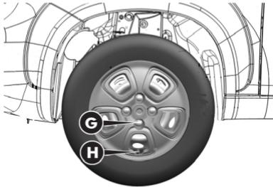
Si el vehículo está equipado con embellecedor, colocarlo con cuidado para que el símbolo de la válvula grabado en la parte trasera del embellecedor
