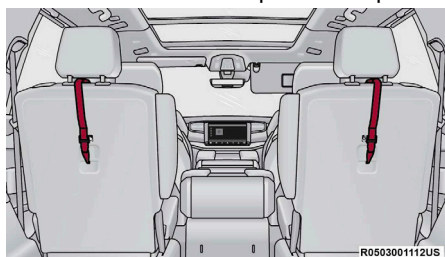
Montaje de la correa de sujeción superior de la silla del capitán
