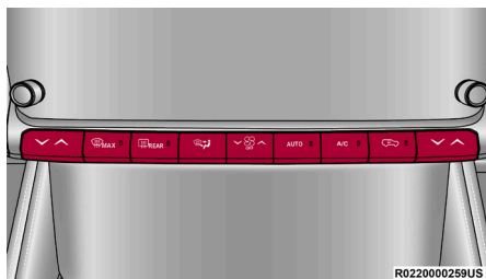
Panel de instrumentos del control del clima
