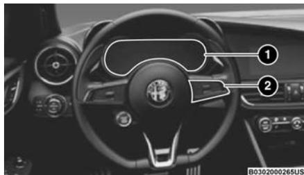
**Ubicación de la pantalla del módulo de instrumentos y controles**
