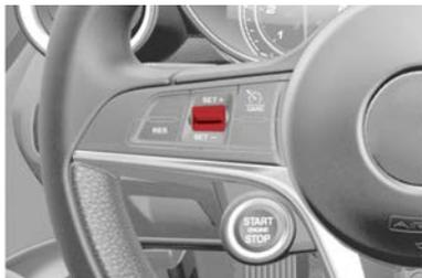
**Interruptor SET del control de velocidad electrónico**
