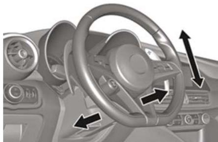
**Ajuste del volante de la dirección**
