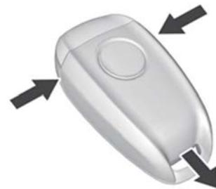
Retiro de la cubierta del transmisor
