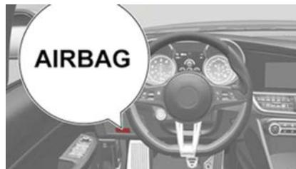
**Bolsa de aire para rodillas del conductor**
