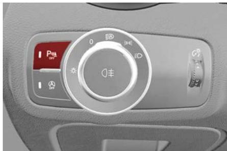
**Interruptor de apagado/encendido**
