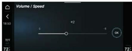
La regulación se puede configurar en 6 posiciones: "off", sistema apagado, y 5 niveles de sensibilidad.
