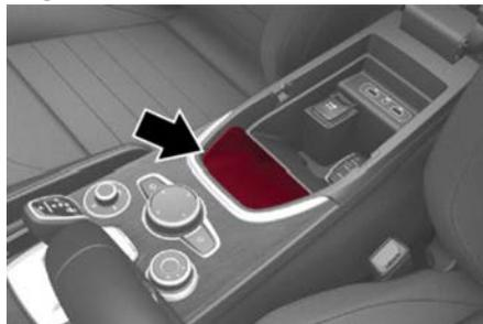
Si el dispositivo es retirado de la superficie de carga, la carga será interrumpida inmediatamente.
