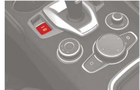
**Interruptor del freno de estacionamiento eléctrico**
