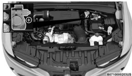
Poste positivo (+) de la batería — Motor 2.0L
