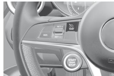
**Botón de apagado/encendido del control electrónico de velocidad de crucero**
