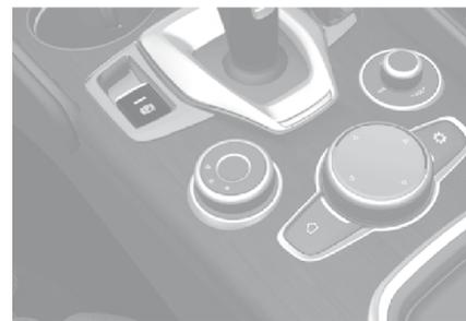
**Interruptor del freno de estacionamiento eléctrico**
