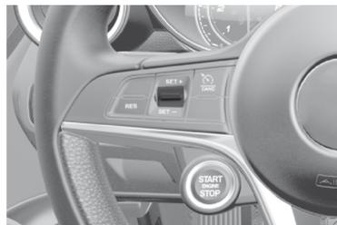
Interruptor SET del control de velocidad electrónico
