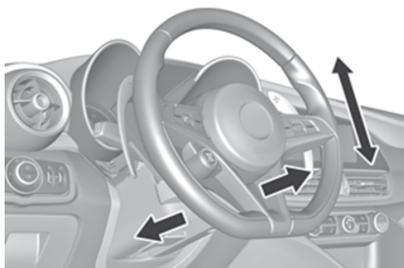
Ajuste del volante de la dirección
