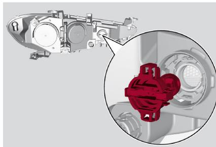
Ensamblaje del conector/foco
