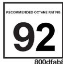
Los motores de gasolina de 2.0L y el 2.9L están diseñados para cumplir con las normas y regulaciones de emisiones y brindarle rendimiento de combustible y un mejor desarrollo usando la Gasolina PREMIUM de 92 octanos. El uso de gasolina de mayor octanaje "Premium" es requerida para estos motores.
