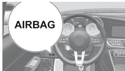
Bolsa de aire para rodillas del conductor
