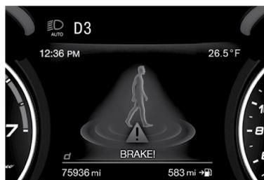
El sistema podría aplicar una ligera frenada para alertar al conductor si detectara un potencial accidente frontal (frenada limitada). Las señales y la frenada limitada tienen como objetivo permitir una rápida reacción del conductor, a fin de poder evitar o atenuar el potencial accidente.
