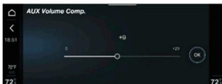
Esta función permite compensar el nivel del volumen en salida del dispositivo conectado.
