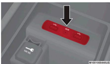
Cuando un dispositivo es conectado al puerto AUX, el sistema reproducirá la fuente AUX a través de las bocinas del vehículo.
