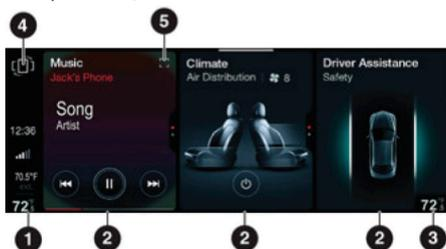
Cada modo (Radio, Teléfono, Medios, Navegación, etc.) tiene un widget dedicado. Los widgets relacionados con las funciones de conectividad de dispositivos externos (Apple CarPlay® o Android Auto™) y las aplicaciones se pueden agregar más adelante. Al activar una aplicación Apple CarPlay® o Android Auto™, el widget aparecerá en la pantalla.
