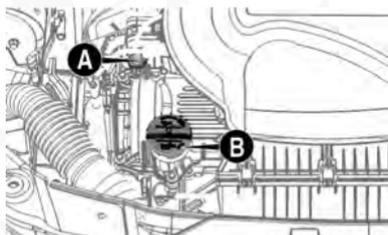
Para el motor 1.4, sacar la varilla de control **A** del nivel de aceite del motor, limpiarla con un paño que no suelte pelusa y ponerla de vuelta en la boca de llenado **A**. Sacarla una segunda vez y asegurarse de que el nivel de aceite del motor que se muestra en la varilla está entre las marcas **MIN** y **MAX** existentes en la misma varilla. El espacio entre ellas corresponde a aproximadamente 1 litro de aceite.
