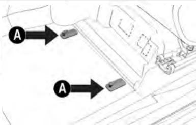
**NOTA:** Para la seguridad del conductor, la alfombra debe fijarse en los elementos de fijación indicados por las flechas A.
