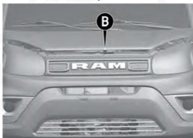
Levante el capó sujetándolo por la parte central. Suelte al varilla de soporte de su dispositivo de bloqueo.
