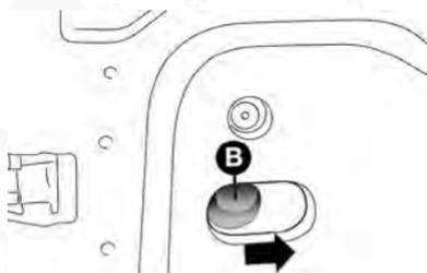
Para abrir la puerta desde el interior del compartimiento de carga, accione la palanca **B** en el sentido de la flecha.
