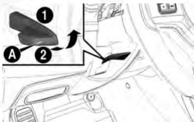
Efectúe el ajuste del volante.
