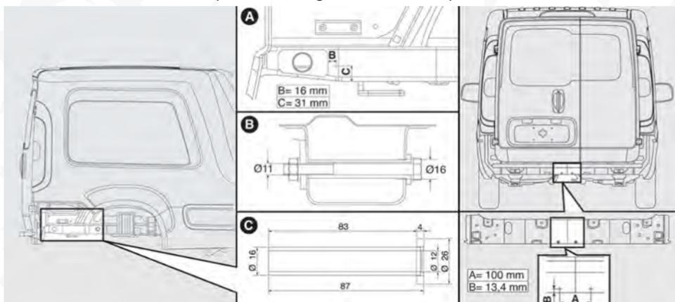
**NOTA:** Los puntos están indicados en sólo uno de los lados. Para colocación del gancho, fije los dos lados. Monte el gancho para remolque según las instrucciones del fabricante.
