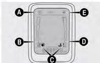
**A** - Indicación de avería en algún componente de iluminación externa. Se enciende junto con el testigo de falla genérica
