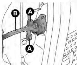
A fin de facilitar el acceso al compartimiento de carga, la puerta trasera tiene un limitador de apertura, que permite mantenerla abierta en dos posiciones 90° y 180°.
