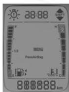
Esta función permite activar o desactivar la bolsa de aire frontal del lado del pasajero a través de los botones ▲ y ▼ en el conjunto de botones ubicado en la parte superior del tablero.
