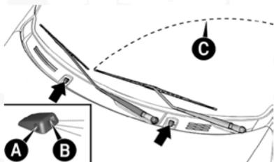
Los pulverizadores A ya salen de fábrica con la dirección del chorro ajustada para a altura ideal en el parabrisas. No es necesario realizar alguna acción adicional.
