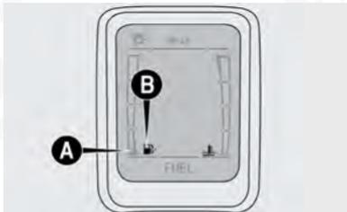
El mensaje "FUEL" se visualiza, destellando durante 10 segundos, después que el depósito alcance el nivel de reserva. El mensaje "FUEL" se visualiza también, destellando durante 10 segundos, después de poner el interruptor de ignición en la posición **MAR** con el nivel de combustible en el depósito en reserva.
