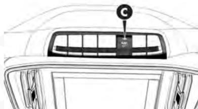
La desactivación del sistema se indica por el encendido del indicador LED en el botón **C** o por el encendido del testigo en el tablero, según la versión.
