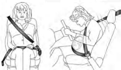
La correa del cinturón de seguridad no debe estar retorcida. La parte superior debe pasar sobre el hombro y atravesar diagonalmente el tórax. La parte inferior debe adherirse a las caderas y no al abdomen del ocupante. No utilizar dispositivos (resortes, cojinetes, etc.) que impidan el contacto de los cinturones de seguridad con el cuerpo de los ocupantes.
