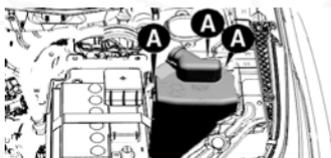
Los números que identifican el elemento eléctrico principal correspondientes a cada fusible, están indicados en la parte interna de la cubierta de la caja de fusibles.
