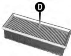
El filtro de aire deberá ser inspeccionado periódicamente y, si se encuentra muy sucio, deberá ser sustituido antes del plazo especificado en el Plan de Mantenimiento Programado de la Póliza de Garantía.
