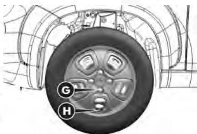
Si el vehículo está equipado con embellecedor, colocarlo con cuidado para que el símbolo de la válvula grabado en la parte trasera del embellecedor
