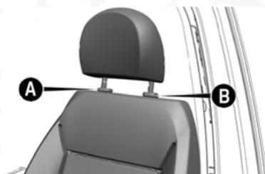
Para desmontar las cabeceras, incline un poco el respaldo, presione el botón del lado izquierdo A y lado derecho B y levante la cabecera hasta liberarla de la tercera traba. Suelte los botones y tire hacia arriba hasta quitar totalmente la cabecera de sus vástagos.
