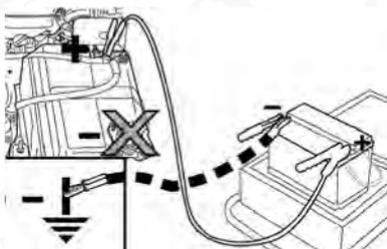
**Arranque con batería auxiliar**
