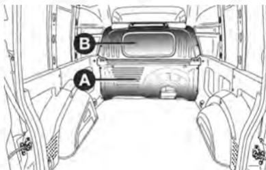
El vehículo tiene una pared divisoria fija de lámina A, totalmente cerrada.
