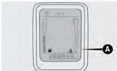
En régimen de funcionamiento normal, el indicador debe estar dentro de los valores centrales de la escala.
