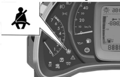
Cuando el vehículo se detiene, si el cinturón de seguridad en el lado del conductor se suelta, la luz sigue encendida de manera fija.
