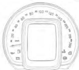
El kilometraje parcial se visualiza en la pantalla LCD, actuando en la extremidad de la palanca derecha, presionando brevemente el botón TRIP.
