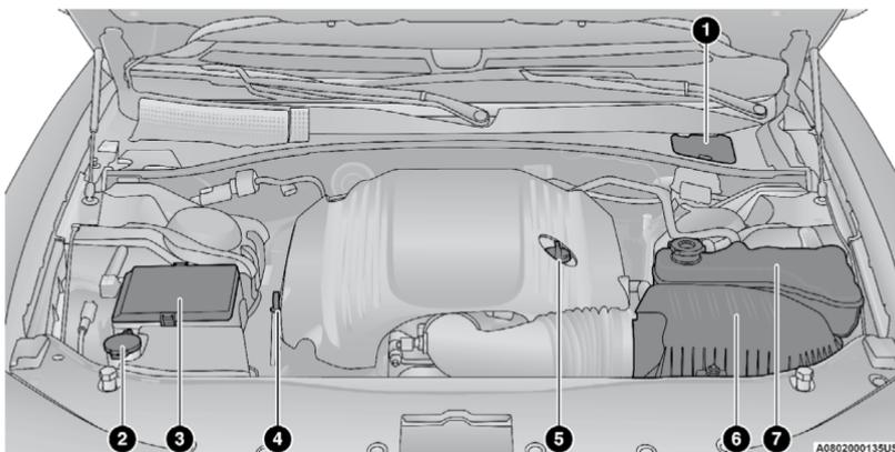
1. Cubierta de acceso a depósito de líquido de frenos.
