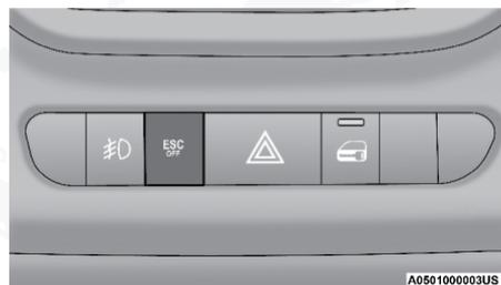
Ubicación del interruptor de apagado del ESC
