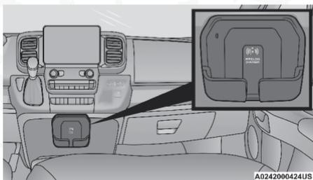
Su vehículo puede estar equipado con una plataforma de carga inalámbrica Qi 3A de 15 W ubicada debajo de la consola central. Esta plataforma de carga está diseñada para cargar de forma inalámbrica su teléfono móvil
