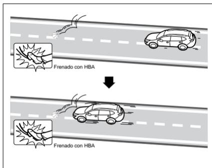
El sistema de asistencia de freno hidráulico (HBA) aprovecha la presión generada rápidamente en el sistema de frenado, ayudando a usted a obtener una menor distancia de parada en emergencias, lo que hace pleno uso de las características del ABS. Una vez soltado el pedal del freno, el HBA se desactiva automáticamente, y el sistema de frenado vuelve al estado de funcionamiento normal.
