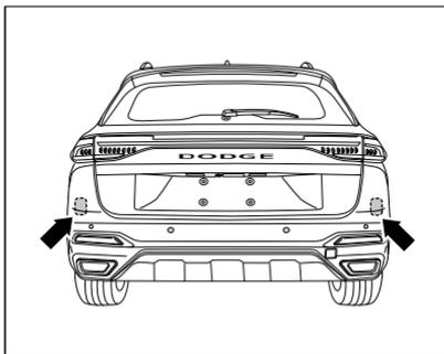
El sensor de radar del sistema de monitoreo de punto ciego se instala como se muestra arriba.
