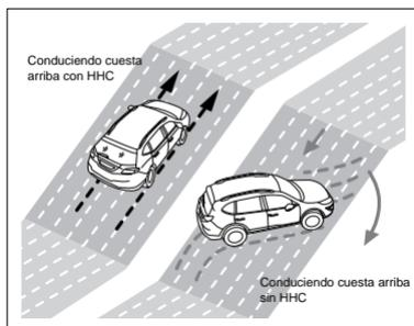
El sistema de control de asistencia en pendientes ascendentes (HHC) permite que, el conductor mueva su pie suavemente del pedal del freno al pedal del acelerador en el arranque en cuesta, cuando no aplica el freno de estacionamiento, para evitar accidentes ocasionados por el desplazamiento.
