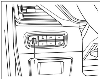
Se puede ajustar manualmente el rango de iluminación del faro delantero mediante el botón giratorio ①, de acuerdo con el cambio de postura del vehículo causado por la carga de los pasajeros y el equipaje, y hay cuatro opciones de posición, que son "0", "1", "2" y "3".
