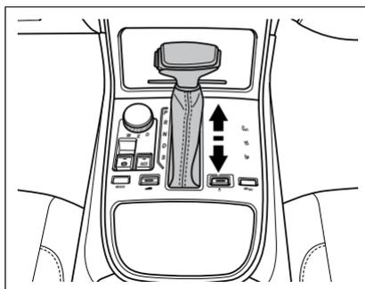
La palanca de cambios está vinculada respectivamente de adelante hacia atrás: “P → R → N → D → S”, después de cambiar la marcha, la luz indicadora de marcha correspondiente en el módulo de cambios se encenderá, y en el tablero de instrumentos se mostrará la marcha correspondiente.
