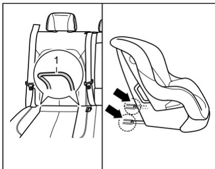
1. Colocar el asiento de seguridad para niños en el asiento del vehículo, encontrar el punto de fijación inferior ① y meter el riel de instalación-flecha-al punto de fijación inferior ①, hasta que escuche el sonido de encaje.
