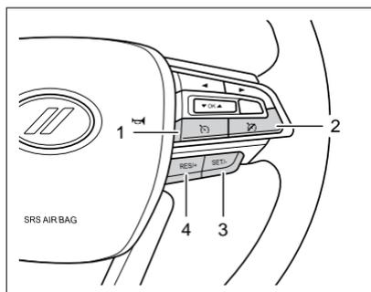
1. Activación / desactivación del control de cruceo a velocidad fija
