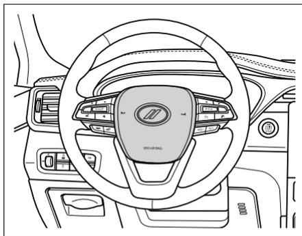
La bolsa de aire frontal del conductor se encuentra dentro del volante (área sombreada), indicada con la leyenda "SRS AIRBAG".
