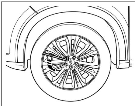
Fije la llave de desmontaje en el perno y afloje el perno en sentido contrario al de las manecillas del reloj.
