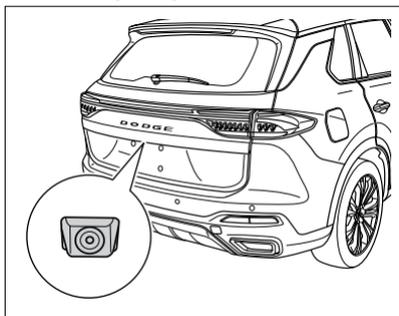
La cámara de visión trasera está montada al lado de la luz de la matrícula.
