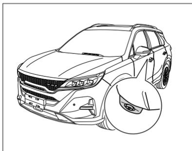
Las cámaras izquierda/derecha están instaladas respectivamente en las partes inferiores de los espejos retrovisores exteriores izquierdo/derecho.
