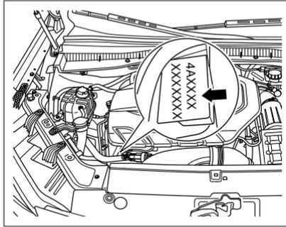
El número de serie del motor se encuentra indicado en la flecha en el bloque del motor (detrás del alternador).
