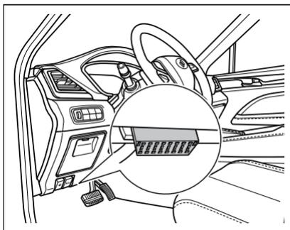
La interfaz OBD para leer el código VIN electrónico se encuentra en la parte inferior izquierda del tablero. Los datos tales como el código VIN electrónico y la información del estado del vehículo se pueden leer con un instrumento de diagnóstico específico.
