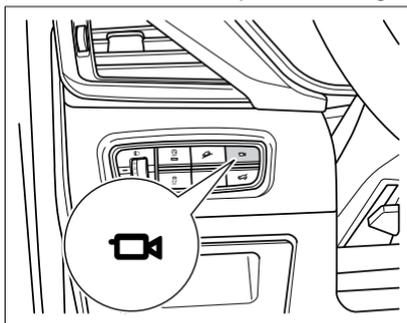
2. Activar y desactivar mediante botones, cuando el interruptor de encendido está en la marcha "ON":
