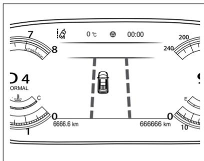
Cuando el tablero de instrumentos muestra que la velocidad es más de 65 km/h y el sistema detecta al menos una línea de carril válida, la luz indicadora del tablero de instrumentos se ilumina en verde. Indica que el sistema puede emitir una alarma de abandono de carril en este momento. Cuando solo hay una línea de carril, el sistema solo alerta el lado con la línea de carril.
