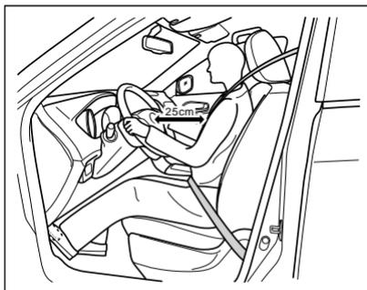
Ajustar el asiento de conductor a la posición correcta para que la distancia entre volante y pecho no sea menor de 25 cm.
