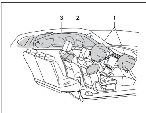
Según las diferentes configuraciones, cuenta con las posiciones de expansión del sistema de bolsas de aire de seguridad como las siguientes:
