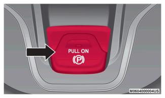
Interruptor del freno de estacionamiento eléctrico
