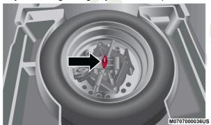
Sujetador del gato y llanta de repuesto
