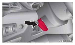
Palanca de control para la inclinación/función telescópica
