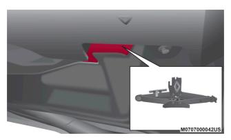
Punto de anclaje del gato en la parte delantera
