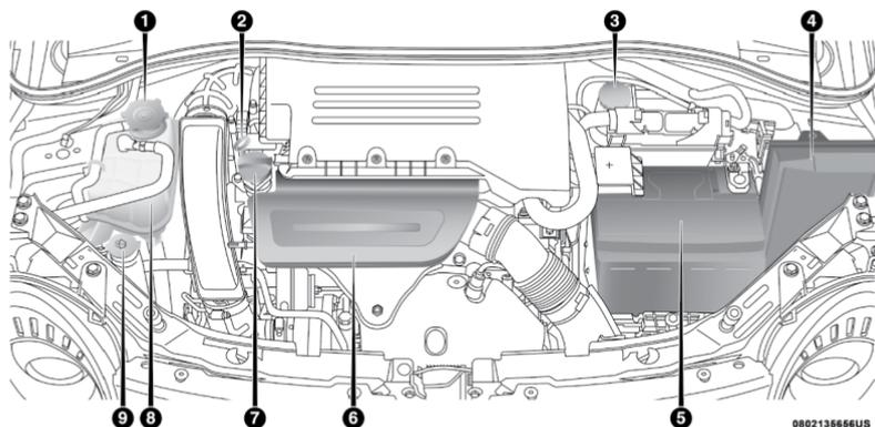
1. Tapón de presión del depósito para el refrigerante
