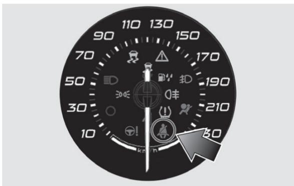
En cuanto se supere el umbral de los 8 km/h durante unos segundos, si los cinturones de seguridad del conductor o del pasajero (si así está equipado) están desabrochados, se activa una señal acústica junto con el parpadeo del testigo
