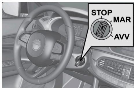
El interruptor de ignición está provisto de un mecanismo de seguridad que obliga, en caso de que el motor no se ponga en marcha, a girar nuevamente la llave a la posición STOP antes de repetir la maniobra de arranque.
