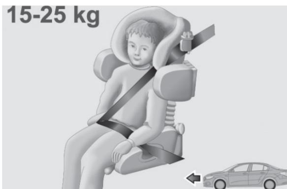
En este caso, las sillas para niños solamente tienen la función de colocar correctamente al niño respecto a los cinturones de seguridad, de modo que el tramo diagonal se adhiera al tórax y no al cuello, y que el tramo horizontal del cinturón de seguridad se adhiera a la pelvis y no al abdomen del niño.
