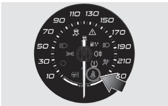
En cuanto se supere el umbral de los 8 km/h durante unos segundos, si los cinturones de seguridad del conductor o del pasajero (si así está equipado) están desabrochados, se activa una señal acústica junto con el parpadeo del testigo
