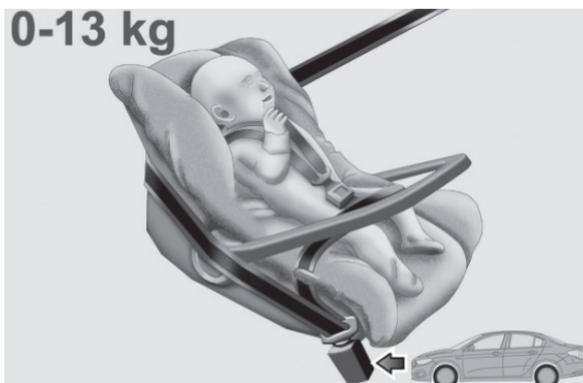
El asiento está limitado por el cinturón de seguridad del vehículo, como se indica en figura y debe a su vez a frenar al niño con sus cinturones incorporados.
