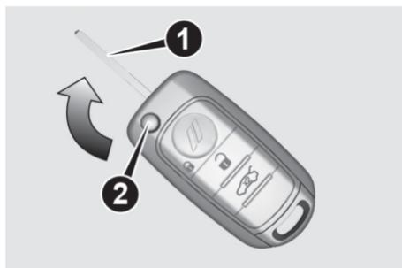
Presionar el botón 2 para abrir/cerrar la pieza metálica.
