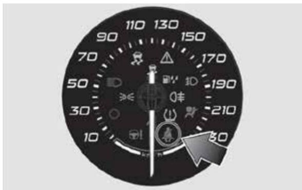
En cuanto se supere el umbral de los 8 km/h durante unos segundos, si los cinturones de seguridad del conductor o del pasajero (si así está equipado) están desabrochados, se activa una señal acústica junto con el parpadeo del testigo
