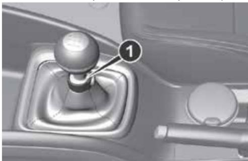
Para engranar la marcha atrás R desde la posición de punto muerto, levantar el anillo (1) situado debajo del pomo y, al mismo tiempo, mover la palanca hacia la izquierda y después hacia delante.
