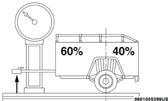
Considere los siguientes puntos cuando calcule el peso del eje trasero del vehículo:
