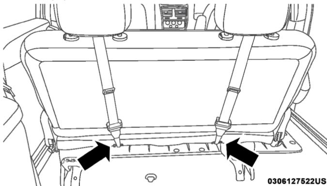
Montaje de la correa de sujeción de los asientos traseros (anclajes de la segunda fila asientos tipo banal)
