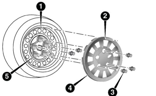
Cubiertas o tapas centrales de la llanta y rueda
