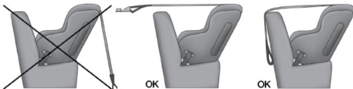
1. Detrás de la posición del asiento donde va a instalar el asiento de seguridad para niño, encontrará el anclaje de sujeción. Puede que tenga que mover el asiento hacia adelante para proporcionar un mejor acceso al anclaje de sujeción. Si no hay correa en la parte superior de anclaje para esa posición, mueva la retención de niño a otra posición en el vehículo, si así está equipado.
