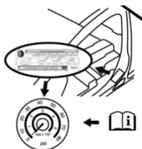
2. La bomba comenzará a inyectar aire en la llanta inmediatamente después de que la botella de sellador este vacía. Continúe operando la bomba e infle las llantas a la presión indicada en la etiqueta de presión de llantas en el pilar del lado del conductor o en la puerta del conductor (presión recomendada). Verifique la presión de la llanta en el indicador de presión.
