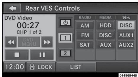
**Selección del “Canal/Screen1” (canal o pantalla 1) y “DISC” (disco) en la columna VES**
