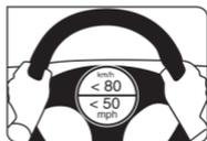
2. Retire la etiqueta de límite de velocidad de la parte superior de la botella de sellador (4) y coloque la etiqueta en el volante.
