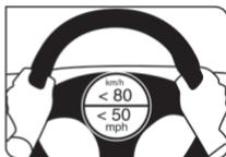
Inmediatamente después de haber inyectado el sellador y haber inflado la llanta, conduzca el vehículo por un lapso de 8 km (5 millas) o 10 minutos para permitir una correcta distribución del sellador en toda la llanta. No exceda los 90 km/h (55 mph).
