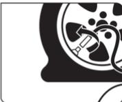
3. Retire el tapón de la válvula de inflado de la llanta y atornille el extremo de la manguera del sellador a la válvula de inflado.
