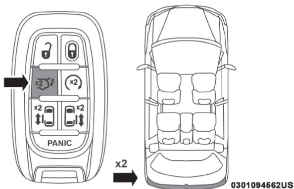
**Desbloqueo de la compuerta trasera usando el control RKE**
