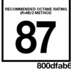
El motor está diseñado para cumplir con todos los reglamentos de emisiones y para proveer un excelente desempeño y rendimiento de combustible, con el uso de gasolina Magna (sin plomo y de alta calidad). El uso de gasolina Premium no aporta ningún beneficio sobre la gasolina Magna en estos motores.
