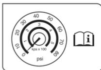
7. Infle la llanta a la presión recomendada de 60 psi (4.2 Bar), según lo indique la etiqueta de la llanta o la etiqueta de “Carga y presión de llanta” en el arco de la puerta del conductor.
