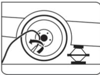
2. Desenrolle la manguera de aire/sellador. Retire la tapa de la válvula de inflado y luego enrosque la manguera del compresor a la válvula de inflado.
