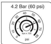
9. Infle la llanta a la presión recomendada de 60 psi (4.2 Bar), según lo indique la etiqueta de la llanta o la etiqueta de “Carga y presión de llanta” en el arco de la puerta del conductor.
