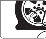
3. Retire la tapa de la válvula de presión y enrosque el adaptador al extremo de la manguera sobre la válvula.
