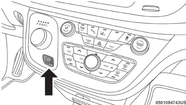
**Interruptor eléctrico del freno de estacionamiento**
