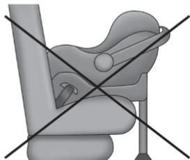
No instale una silla viendo hacia atrás usando un soporte trasero de piernas en el vehículo. El piso de este vehículo no está diseñado para manejar las fuerzas en caso de un choque con este tipo de asientos. En un choque, el soporte a las piernas no funcionará como fue diseñado y el niño podría salir severamente lastimado como resultado.
