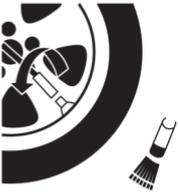
5. Desenrede la manguera y conecte a la válvula de inflado de la llanta.
