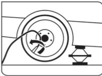
3. Instale la llanta de refacción inflable como se describió anteriormente en este manual. Asegúrese que la válvula de inflado de la llanta se encuentre cerca del piso, y luego enrosque la manguera del compresor a la válvula de inflado.
