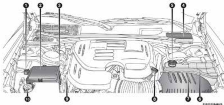
1. Arranque con cables pasa corriente (Polo positivo de la batería)
