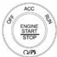
Esta función permite al conductor hacer funcionar el interruptor de ignición con la presión de un botón, siempre y cuando esté instalado el botón Arranque/Paro del motor y el transmisor de llave de esté dentro del compartimiento de pasajeros.
