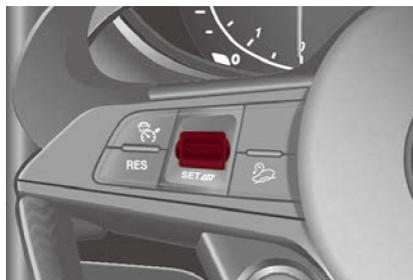
**Interruptor SET del control de velocidad electrónico**
