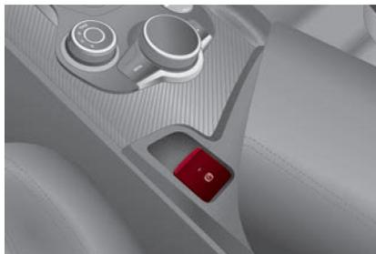
**Interruptor del freno de estacionamiento eléctrico**
