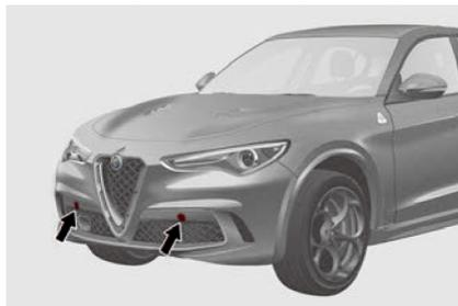
Cubierta para remolque con argolla frontal
