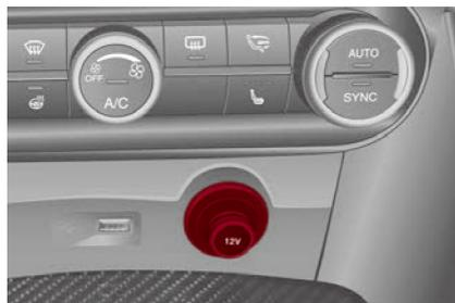
Toma de corriente del panel de instrumentos
