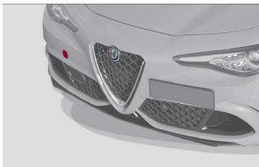
Dispositivo delantero para remolcar con argolla
