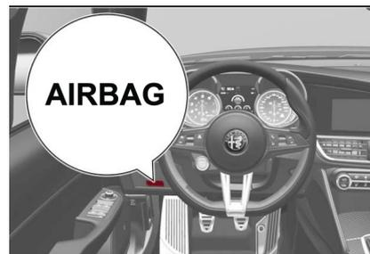
Bolsa de aire para rodillas del conductor
