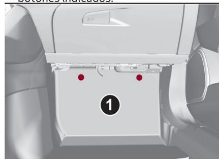
2. Quitar el panel deslizándolo hacia abajo después de haber desarmado los dos enganches de fijación.
