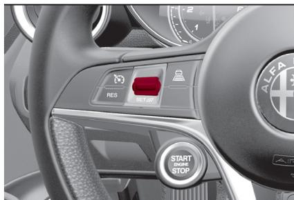
**Interruptor SET del control de velocidad electrónico**
