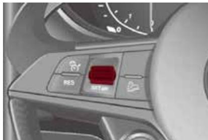
**Interruptor SET del control de velocidad electrónico**
