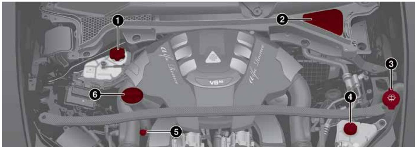
1. Tapón del depósito del líquido refrigerante del motor
