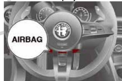
Protector/bolsa de aire de rodillas del conductor
