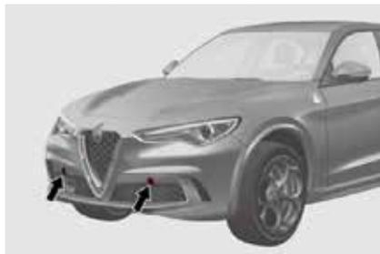
Cubierta para remolque con argolla frontal
