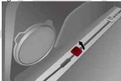
Levante el gancho de fijación móvil para usarlo
