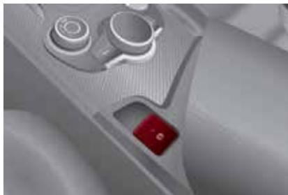
**Interruptor del freno de estacionamiento eléctrico**
