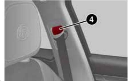
Anclaje superior ajustable del cinturón de seguridad
