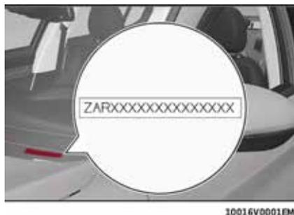
Este número también está grabado en el bastidor, en la fijación del amortiguador delantero derecho, y se ve al abrir el cofre.
