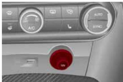
Toma de corriente del panel de instrumentos
