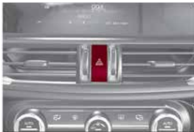
Interruptor de las luces de emergencia
