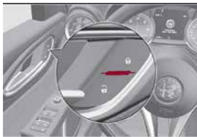
Interruptores de bloqueo y desbloqueo de puertas
