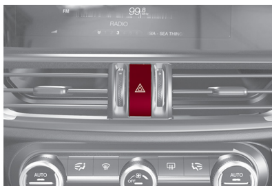
Interruptor de las luces de emergencia
