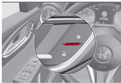
Interruptores de bloqueo y desbloqueo de puertas
